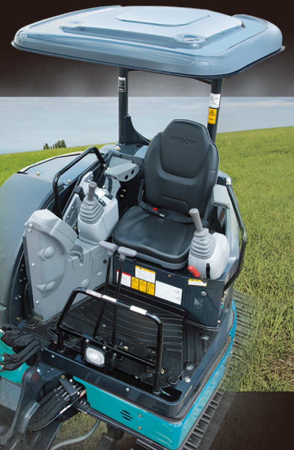
AX30u (2柱キャノピ、エキストラ配管仕様) ※オプションの4面補強アームおよび鉄クローラ、バケットシリンダガード、ホースプロテクタ、アームレスト付き
