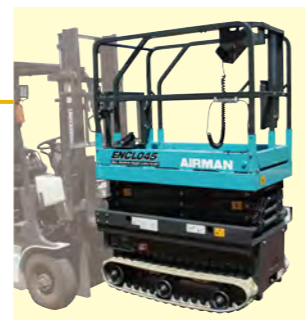
新たに追加された 縦方向のフォークポケット <運搬イメージ>
