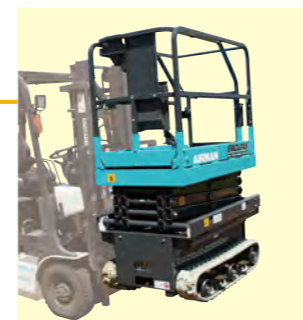
横方向の フォークポケット <運搬イメージ>
